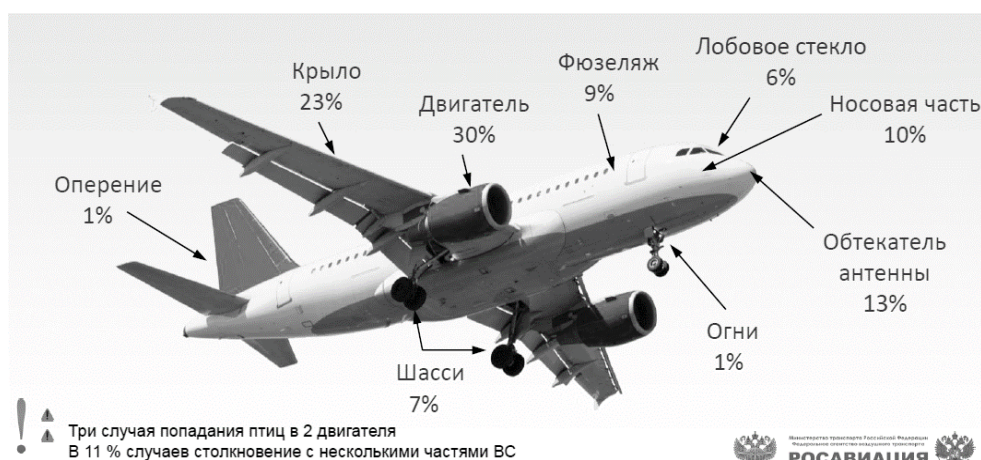
Рис. 3 / Fig. 3. Анализ данных о столкновениях воздушных судов с птицами / Analysis of data on aircraft collisions with birds
