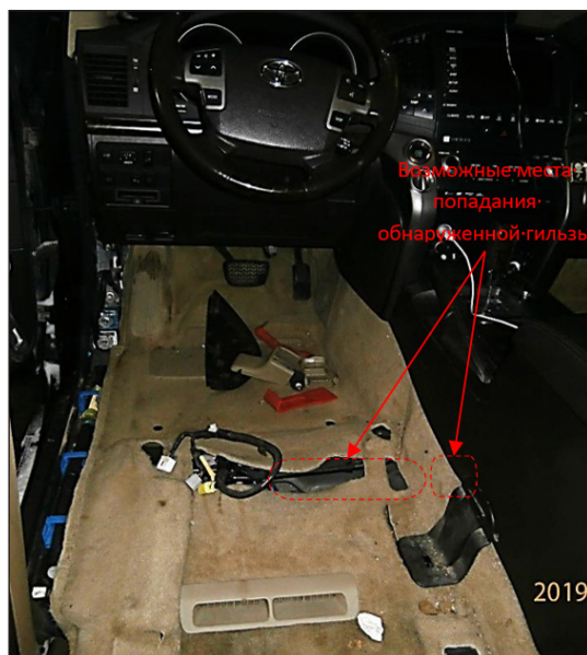
Рис. 6 / Fig. 6. Вид напольного покрытия под водительским сидением автомобиля Тойота Ленд Крузер 200, стрелками указаны технологические отверстия / The view of the floor covering under the driver's seat of the Toyota Land Cruiser 200, the arrows indicate the technological holes
